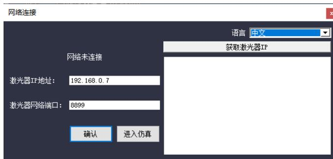
2、对装有操作界面的本地电脑需要进行如下设置：IP地址：192.168.0.xxx（xxx不能设置为激光器的IP地址）；子网掩码：255.255.255.0；默认网关：192.168.0.1
